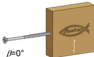
Abbildung D6.1: Schraubenanordnung in der Schmalseite von WBP (Abbildung nicht maßstäblich)
