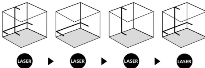
! Til horizontal og vertikal nivellering skal transportsikringen være løsnet. Så snart apparatet er uden for det automatiske nivelleringsområde på 3,5°, blinker laserlinjerne. Apparatet skal positioneres således, at det er inden for nivelleringsområdet. Laserlinjerne lyser konstant op igen.
