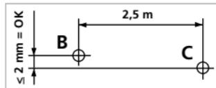
Sie, ob die waagerechte Linie von Punkt C  $\pm 2$  mm auf der gleichen Höhe mit dem Punkt B liegt. Vorgang durch Schwenken nach links wiederholen.
