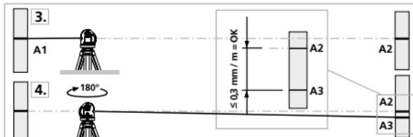
Wanneer het verschil tussen punt A2 en A3 groter is dan de aangegeven tolerantie, nl. 0,3 mm / m, is een kalibratie nodig. Neem hiervoor contact op met uw vakhandelaar of met de serviceafdeling van UMAREX-LASERLINER.
